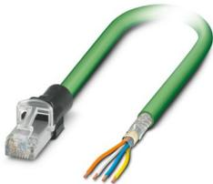
Patch-Kabel, RJ45/IP20 gerade, Kabellänge: 0,5 m, Polzahl: 4, 100 MBit/s, CAT5, PROFINET, 1x4xAWG22/7, SF/TQ, grün RAL 6018
