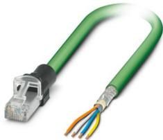
Patch-Kabel, RJ45/IP20 gerade, Kabellänge: 1 m, Polzahl: 4, 100 MBit/s, CAT5, PROFINET, 1x4xAWG22/7, SF/TQ, grün RAL 6018
