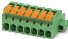
Leiterplattenstecker, Nennquerschnitt: 2,5 mm<sup>2</sup>, Farbe: grün, Nennstrom: 16 A, Bemessungsspannung (III/2): 320 V, Kontaktoberfläche: Sn, Kontaktart: Buchse, Anzahl der Reihen: 1, Polzahl: 7, Artikelfamilie: LPC 2,5/..-STF, Rastermaß: 5,08 mm, Anschlussart: Hebel-Push-in-Anschluss, Anschlussrichtung Leiter/Platine: 0 °, Rasthaken: - ohne Rasthaken, Stecksystem: COMBICON MSTB 2,5, Verriegelung: Schraubverriegelung, Befestigungsart: Schraubflansch, Verpackungsart: verpackt im Karton
