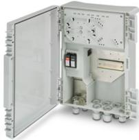
Smart Ethernet Box zum Anschließen von PoE-Endgeräten, zwei PoE-Ports, zwei Uplink-Ports (SFP-Slots), Managed Switch, Überspannungsschutz und Spleißkassette integriert, Versorgungsspannung 100 ... 240 V AC, Wand- oder Mastmontage
