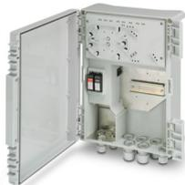
Smart Ethernet Box zum Anschließen von PoE-Endgeräten, vier PoE-Ports, zwei Uplink-Ports (RJ45), Managed Switch und Überspannungsschutz integriert, Versorgungsspannung 100 ... 240 V AC, Wand- oder Mastmontage
