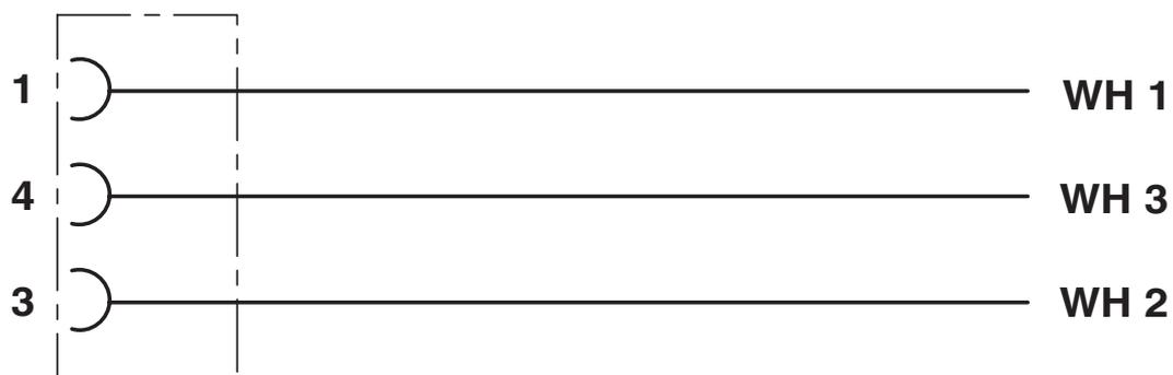
Kontaktbelegung der M12-Buchse
