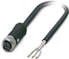
Sensor-/Aktor-Kabel, 3-polig, PE-X halogenfrei, schwarz, geschirmt, freies Leitungsende, auf Buchse gerade M12 SPEEDCON, Kodierung: A, Kabellänge: 3 m, für Bahnanwendungen
