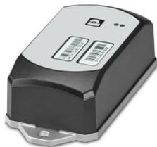
GNSS-Empfänger, NTP- und NTS-Zeitserver (Network Time Protocol, Network Time Security) für Ethernet-Netzwerke, empfängt Zeit, Datum und Standort über GPS, Galileo, GLONASS, BeiDou, Versorgung über PoE (af) oder 24 V DC, integrierte Antenne, IP68-Gehäuse
