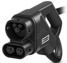
CHARX connect standard, CCS Typ 2, DC-Ladeleitung, bis zu 500 A im Boost Mode, 200 A dauerhaft, 1000 V DC, mit Fahrzeug-Ladestecker und offenem Leitungsende, schwarz, gerade, mit angeschlossenem PP-Kontakt, mit austauschbarem Steckgesichtrahmen, mit analoger Temperatursensoren, PHOENIX CONTACT-Logo, IEC 62196-3, zum Laden mit Gleichstrom (DC) von Elektrofahrzeugen (EV)
