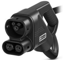
CHARX connect standard, CCS Typ 2, DC-Ladeleitung, bis zu 500 A im Boost Mode, 200 A dauerhaft, 1000 V DC, mit Fahrzeug-Ladestecker und offenem Leitungsende, Kabel: 6,5 m, schwarz, gerade, mit angeschlossenem PP-Kontakt, mit austauschbarem Steckgesichtrahmen, mit analoger Temperatursensorik, PHOENIX CONTACT-Logo, IEC 62196-3, zum Laden mit Gleichstrom (DC) von Elektrofahrzeugen (EV)
