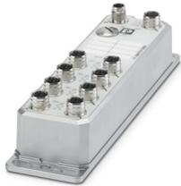
Managed Switch 2000 Serie, 8 M12-Ports 10/100/1000 MBit/s, Schutzart: IP65/IP66/IP67, Umgebungstemperatur (Betrieb): -40 °C ... 70 °C, Versorgungsspannungsbereich: 9 V DC ... 57 V DC, PROFINET Conformance-Class B, Erweiterter Temperaturbereich, PROFINET-Mode voreingestellt, PROFINET-Status LEDs, Entwicklungsprozess zertifiziert nach IEC 62443-4-1, Kompatibel zu IEC 62443-4-2
