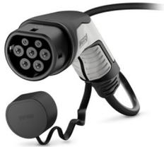
CHARX connect comfort, Typ 2, AC-Ladeleitung, 32 A dauerhaft, 250 V AC, mit Fahrzeug-Ladestecker und offenem Leitungsende, Kabel: 2 m, schwarz, gerade, mit Schutzkappe, Gehäuse: schwarz, grau, PHOENIX CONTACT-Logo, IEC 62196-2, zum Laden mit Wechselstrom (AC) von Elektrofahrzeugen (EV) mit Typ 2 Fahrzeug-Ladedosen
