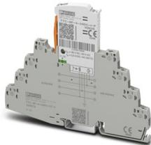
Überspannungsschutz, bestehend aus Schutzstecker und Basiselement, mit integrierter Statusanzeige für einen 4-adrigen erdpotenzialfrei betriebenen Signalkreis mit hohem Nennstrom. Ideal für 4-Leiter-Messungen z. B. von Temperaturen und Gewichten. In sicherheitsgerichteten Kreisen bis SIL 3 einsetzbar.
