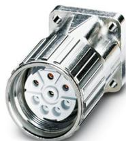
Gerätesteckverbinder Vorderwand mit Rändelmutter, gerade, Schraubverriegelung, M23, Polzahl: 4+3+PE, Kontaktart: Buchse, O-Ring axial, geschirmt: ja, Flanschmaß: 26 mm x 26 mm, Kabeldurchmesserbereich: 0 mm ... 0 mm, Polzahl: 8, Anschlussart: Crimpanschluss, Serie: SF, dieser Artikel ist voraussichtlich ab 2027-Q1 nach RoHS II ohne Ausnahme 6c (Pb < 0,1 %) bleifrei, auf Anfrage ist eine bleifreie Alternative vorab möglich
