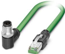
Netzwerkkabel, PROFINET CAT5 (100 MBit/s), EtherCAT® CAT5 (100 MBit/s), 4-polig, PUR halogenfrei, grün RAL 6018, geschirmt (Advanced Shielding Technology), Stecker gewinkelt M12, Kodierung: D / IP67, auf Stecker gerade RJ45 / IP20, Kabellänge: 30 m
