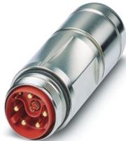
M40, Kupplungssteckverbinder, Serie: SB, gerade lang, geschirmt: ja, für Standard- und SPEEDCON-Verriegelung, Polzahl: 4+4+PE / 3+N+PE, Kontaktart: Stift, Crimpanschluss, Kabeldurchmesserbereich: 14 mm ... 20,5 mm, Kodierung: Signal, Kodierung 1, dieser Artikel ist voraussichtlich ab 2025-Q3 nach RoHS II ohne Ausnahme 6c (Pb < 0,1 %) bleifrei, auf Anfrage ist eine bleifreie Alternative vorab möglich
