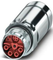
M23, Kupplungssteckverbinder, Serie: SH, gerade lang, geschirmt: ja, für Standard- und SPEEDCON-Verriegelung, Polzahl: 4+4+PE / 3+N+PE, Kontaktart: Stift, Crimpanschluss, Kabeldurchmesserbereich: 7,5 mm ... 18 mm, dieser Artikel ist voraussichtlich ab 2026-Q1 nach RoHS II ohne Ausnahme 6c (Pb < 0,1 %) bleifrei, auf Anfrage ist eine bleifreie Alternative vorab möglich
