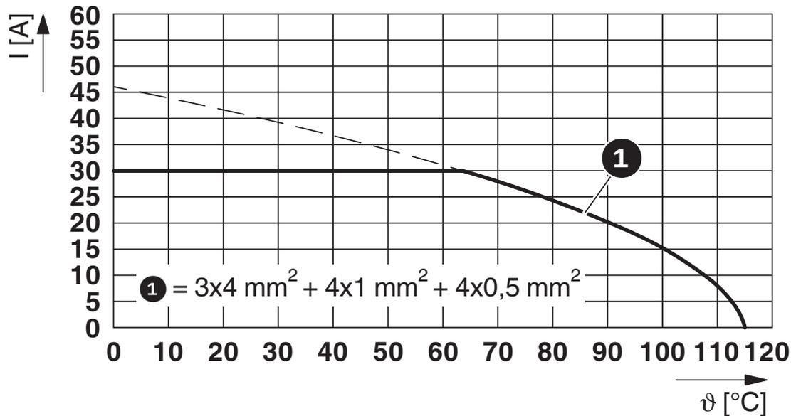
$I$  = Stromstärke,  $\vartheta$  = Umgebungstemperatur, Leistungskontakte A-C: 3 x bis 30 A, Signalkontakte: 4 x 2 A konstant, Datenkontakte: 4 x 1 A konstant
