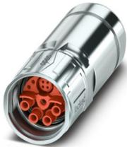
M23, Kabelsteckverbinder, Serie: SH, gerade lang, geschirmt: ja, SPEEDCON, Polzahl: 4+4+PE / 3+N+PE, Kontaktart: Buchse, Crimpanschluss, Kabeldurchmesserbereich: 12 mm ... 15 mm, dieser Artikel ist voraussichtlich ab 2027-Q1 nach RoHS II ohne Ausnahme 6c (Pb < 0,1 %) bleifrei, auf Anfrage ist eine bleifreie Alternative vorab möglich
