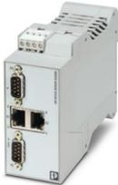
Der GW PN/MODBUS... ermöglicht die Zwei-Wege-Kommunikation zwischen PROFINET- und Modbus-Protokollen. Umfasst zwei RJ45-Anschlüsse und zwei D-SUB-9-Anschlüsse.
