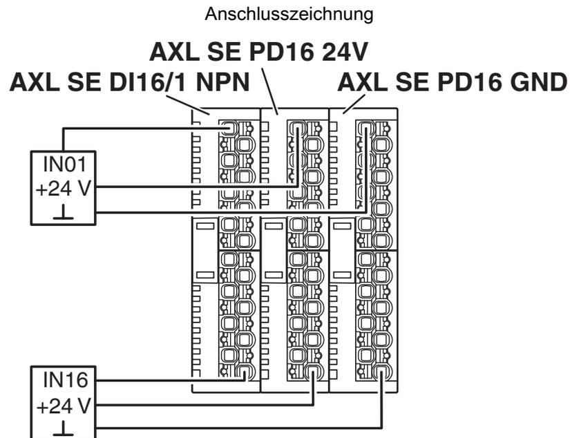
Anschluss in 3-Leiter-Technik bei Verwendung von AXL SE PD ... (siehe Datenblatt)
