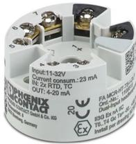
Ausgangsschleifengespeister Kopftransmitter zur Übertragung von bis zu 2 Sensorsignalen von RTD- und TC-Sensoren sowie von Widerstands- und Spannungsausgebern über 4 mA ... 20 mA. HART, Standardkonfiguration, Safety Integrity Level (SIL, IEC 61508): 2, Systematic Capability: 3, Schraubanschluss
