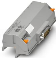
V8-Adapter für 8 x PLC-INTERFACE (14 mm), Anschluss 1: D-SUB-Stiftleiste 1x 15-polig, Anschluss 2: Steckanschluss (Aufrastbar auf 8x PLC-INTERFACE-Klemmen), Anschluss 3: Schraubanschluss 1x 2-polig, Anzahl der Kanäle: 8, Ansteuerlogik: plusschaltend
