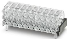
Mehrfachlichtleiter mit Überstrahlungsschutz, passiv, starr, Linsenkopf, Abstrahlfläche: sphärisch, Anzahl der Anzeigen: 30, (3 Reihen, 10 Spalten), Rastermaß: 2,54 mm, ESD-Schutz: <8 kV, nutzbar für die Gehäusefamilien ME, ME MAX, ME-IO, ME PLC und EH (Bearbeitung des Gehäuses erforderlich)
