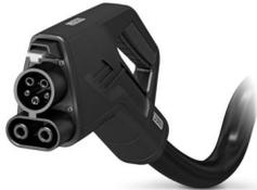
CHARX connect standard, CCS Typ 1, DC-Ladeleitung, bis zu 500 A im Boost Mode, 200 A dauerhaft, 1000 V DC, mit Fahrzeug-Ladestecker und offenem Leitungsende, Kabel: 25 ft, schwarz, gerade, mit Ladesteckerhalterung, mit analoger Temperatursensoren, PHOENIX CONTACT-Logo, ACHTUNG: Kabelmanagement ggf. erforderlich., SAE J1772, IEC 62196-3, zum Laden mit Gleichstrom (DC) von Elektrofahrzeugen (EV)
