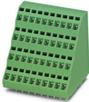
Leiterplattenklemme, Nennstrom: 12 A, Bemessungsspannung (III/2): 400 V, Nennquerschnitt: 1,5 mm<sup>2</sup>, Anzahl der Reihen: 4, Polzahl pro Reihe: 11, Artikelfamilie: ZFK4DS(A) 1,5, Rastermaß: 5,08 mm, Anschlussart: Zugfederanschluss, Montage: Wellenlöten, Anschlussrichtung Leiter/Platine: 45 °, Farbe: grün, Pin-Layout: Lineares Pinning, Pinlänge [P]: 3,4 mm, Anzahl der Lötpins pro Potenzial: 1, Verpackungsart: verpackt im Karton
