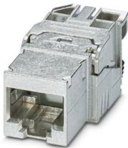
RJ45-Buchseneinsatz, Bauform: RJ45, Schutzart: IP20, Polzahl: 8, 10 GBit/s, CAT6<sub>A</sub>, Material: Metall, Anschlussart: IDC-Anschluss, Anschlussquerschnitt: AWG 26- 22, Kabelabgang: gerade, adapterlose Ausführung, Ethernet
