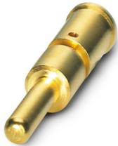
Crimpkontakt, Serie: VARIOCON, Stift, gedreht, Kontaktdurchmesser: 2 mm, Anschlussquerschnitt: 1,5 mm<sup>2</sup> ... 2,5 mm<sup>2</sup>, AWG 14...14, Material Kontakt: Cu, dieser Artikel ist voraussichtlich ab 2027-Q1 nach RoHS II ohne Ausnahme 6c (Pb < 0,1 %) bleifrei, auf Anfrage ist eine bleifreie Alternative vorab möglich
