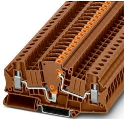
Messwandler-Trennklemme, Nennspannung: 500 V, Nennstrom: 30 A, 1. Etage, Anschlussart: Schraubanschluss, Bemessungsquerschnitt: 6 mm<sup>2</sup>, Querschnitt: 0,2 mm<sup>2</sup> - 10 mm<sup>2</sup>, Montage: NS 35/7,5, NS 35/15, Farbe: braun
