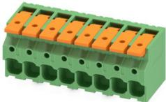
Leiterplattenklemme, Nennstrom: 41 A, Bemessungsspannung (III/2): 1000 V, Nennquerschnitt: 6 mm<sup>2</sup>, Anzahl der Potenziale: 8, Anzahl der Reihen: 1, Polzahl pro Reihe: 8, Artikelfamilie: LPT 6/, Rastermaß: 7,5 mm, Anschlussart: Hebel-Push-in-Anschluss, Montage: Wellenlöten, Anschlussrichtung Leiter/Platine: 0 °, Farbe: grün, Pin-Layout: Zick-Zack-Pinning W, Pinlänge [P]: 3,6 mm, Verpackungsart: verpackt im Karton
