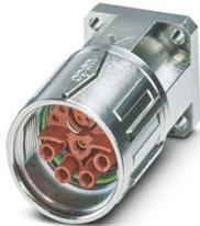
M23, Gerätesteckverbinder Vorderwand mit Rändelmutter, Serie: SH, gerade, geschirmt: ja, SPEEDCON, Polzahl: 4+4+4+PE / 3+N+PE, Kontaktart: Buchse, Crimpanschluss, O-Ring axial, Flanschmaß: 26 mm x 26 mm
