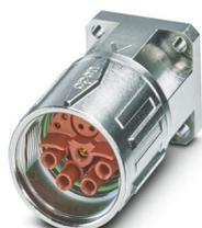
M23, Gerätesteckverbinder Vorderwand mit Rändelmutter, Serie: SH, gerade, geschirmt: ja, SPEEDCON, Polzahl: 8+4+PE, Kontaktart: Buchse, Crimpanschluss, O-Ring axial, Flanschmaß: 26 mm x 26 mm
