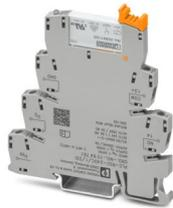
PLC-INTERFACE, bestehend aus Grundklemme mit Schraubanschluss und steckbarem Miniaturrelais mit interner Verstärkerschaltung und einer entsprechenden Hilfsversorgung für schwache Signalquellen, 1-Schließer, Eingangsnennspannung 24 V DC
