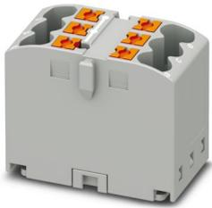
Verteilerblock, Grundklemme, Nennspannung: 450 V, Nennstrom: 24 A, Anzahl der Anschlüsse: 6, Anschlussart: Push-in-Anschluss, Querschnitt: 0,14 mm<sup>2</sup> - 4 mm<sup>2</sup>, Montageart: aufrasten auf Tragschienenadapter, Direktmontage mit Flansch, Fliegend, Farbe: grau
