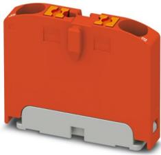
Monoblock, Grundklemme, Nennspannung: 450 V, Nennstrom: 24 A, Anzahl der Anschlüsse: 2, Anschlussart: Push-in-Anschluss, Querschnitt: 0,14 mm<sup>2</sup> - 4 mm<sup>2</sup>, Montageart: aufrasten auf Tragschienenadapter, Direktmontage mit Flansch, Fliegend, Farbe: rot
