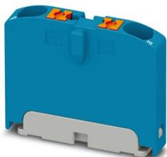
Monoblock, Grundklemme, Nennspannung: 450 V, Nennstrom: 24 A, Anzahl der Anschlüsse: 2, Anschlussart: Push-in-Anschluss, Querschnitt: 0,14 mm<sup>2</sup> - 4 mm<sup>2</sup>, Montageart: aufrasten auf Tragschienenadapter, Direktmontage mit Flansch, Fliegend, Farbe: blau
