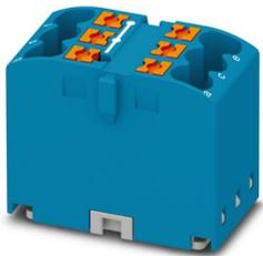
Verteilerblock, Grundklemme, Nennspannung: 450 V, Nennstrom: 24 A, Anzahl der Anschlüsse: 6, Anschlussart: Push-in-Anschluss, Querschnitt: 0,14 mm<sup>2</sup> - 4 mm<sup>2</sup>, Montageart: aufrasten auf Tragschienenadapter, Direktmontage mit Flansch, Fliegend, Farbe: blau
