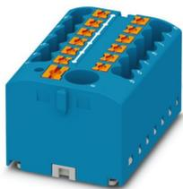
Verteilerblock, Grundklemme mit Einspeisung, Nennspannung: 450 V, Nennstrom: 24 A, Anzahl der Anschlüsse: 13, Anschlussart: Push-in-Anschluss, Bemessungsquerschnitt: 2,5 mm<sup>2</sup>, Abgriff, Querschnitt: 0,14 mm<sup>2</sup> - 4 mm<sup>2</sup>, Push-in-Anschluss, Sammelanschluss, Bemessungsquerschnitt: 6 mm<sup>2</sup>, Querschnitt: 0,5 mm<sup>2</sup> - 10 mm<sup>2</sup>, Montageart: aufrasten auf Tragschienenadapter, Direktmontage mit Flansch, Fliegend, Farbe: blau
