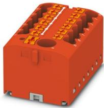
Verteilerblock, Grundklemme mit Einspeisung, Nennspannung: 450 V, Nennstrom: 24 A, Anzahl der Anschlüsse: 13, Anschlussart: Push-in-Anschluss, Bemessungsquerschnitt: 2,5 mm<sup>2</sup>, Abgriff, Querschnitt: 0,14 mm<sup>2</sup> - 4 mm<sup>2</sup>, Push-in-Anschluss, Sammelschluss, Bemessungsquerschnitt: 6 mm<sup>2</sup>, Querschnitt: 0,5 mm<sup>2</sup> - 10 mm<sup>2</sup>, Montageart: aufrasten auf Tragschienenadapter, Direktmontage mit Flansch, Fliegend, Farbe: rot
