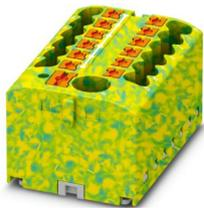
Verteilerblock, Grundklemme mit Einspeisung ohne Schutzleiterfunktion, Nennspannung: 450 V, Nennstrom: 24 A, Anzahl der Anschlüsse: 13, Anschlussart: Push-in-Anschluss, Bemessungsquerschnitt: 2,5 mm<sup>2</sup>, Abgriff, Querschnitt: 0,14 mm<sup>2</sup> - 4 mm<sup>2</sup>, Push-in-Anschluss, Sammelschluss, Bemessungsquerschnitt: 6 mm<sup>2</sup>, Querschnitt: 0,5 mm<sup>2</sup> - 10 mm<sup>2</sup>, Montageart: Fliegend, Farbe: grün/gelb
