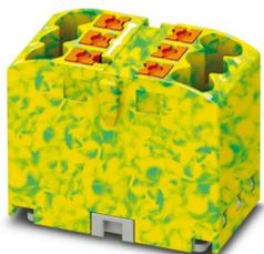
Verteilerblock, Grundklemme ohne Schutzleiterfunktion, Nennspannung: 450 V, Nennstrom: 24 A, Anzahl der Anschlüsse: 6, Anschlussart: Push-in-Anschluss, Querschnitt: 0,14 mm<sup>2</sup> - 4 mm<sup>2</sup>, Montageart: Fliegend, Farbe: grün/gelb
