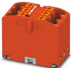
Verteilerblock, Grundklemme, Nennspannung: 450 V, Nennstrom: 24 A, Anzahl der Anschlüsse: 6, Anschlussart: Push-in-Anschluss, Querschnitt: 0,14 mm<sup>2</sup> - 4 mm<sup>2</sup>, Montageart: aufrasten auf Tragschienenadapter, Direktmontage mit Flansch, Fliegend, Farbe: rot
