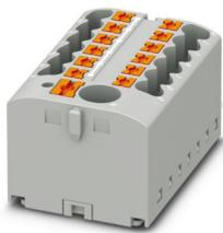
Verteilerblock, Grundklemme mit Einspeisung, Nennspannung: 450 V, Nennstrom: 24 A, Anzahl der Anschlüsse: 13, Anschlussart: Push-in-Anschluss, Bemessungsquerschnitt: 2,5 mm<sup>2</sup>, Abgriff, Querschnitt: 0,14 mm<sup>2</sup> - 4 mm<sup>2</sup>, Push-in-Anschluss, Sammelanschluss, Bemessungsquerschnitt: 6 mm<sup>2</sup>, Querschnitt: 0,5 mm<sup>2</sup> - 10 mm<sup>2</sup>, Montageart: aufrasten auf Tragschienenadapter, Direktmontage mit Flansch, Fliegend, Farbe: grau
