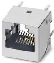
RJ45-Leiterplatten-Steckverbinder, Bauform: RJ45, Polzahl: 8, 10 GBit/s, THR-Löten, Schutzart: IP20, Anschlussart: THR-Reflow / THT-Welle, Tray
