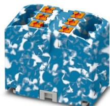
Verteilerblock, Grundklemme, Nennspannung: 450 V, Nennstrom: 24 A, Anzahl der Anschlüsse: 6, Anschlussart: Push-in-Anschluss, Querschnitt: 0,14 mm<sup>2</sup> - 4 mm<sup>2</sup>, Montageart: aufrasten auf Tragschienenadapter, Direktmontage mit Flansch, Fliegend, Farbe: blau/weiß
