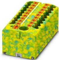
Verteilerblock, Grundklemme mit Einspeisung ohne Schutzleiterfunktion, Nennspannung: 450 V, Nennstrom: 24 A, Anzahl der Anschlüsse: 19, Anschlussart: Push-in-Anschluss, Bemessungsquerschnitt: 2,5 mm<sup>2</sup>, Abgriff, Querschnitt: 0,14 mm<sup>2</sup> - 4 mm<sup>2</sup>, Push-in-Anschluss, Sammelschluss, Bemessungsquerschnitt: 6 mm<sup>2</sup>, Querschnitt: 0,5 mm<sup>2</sup> - 10 mm<sup>2</sup>, Montageart: Fliegend
