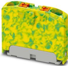
Monoblock, Grundklemme ohne Schutzleiterfunktion, Nennspannung: 450 V, Nennstrom: 24 A, Anzahl der Anschlüsse: 2, Anschlussart: Push-in-Anschluss, Querschnitt: 0,14 mm<sup>2</sup> - 4 mm<sup>2</sup>, Montageart: Fliegend, Farbe: grün/gelb
