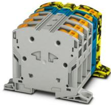
Hochstromklemme, mit Prüfbuchse, Nennspannung: 1000 V, Nennstrom: 150 A, Anzahl der Anschlüsse: 8, Polzahl: 5, Anschlussart: PowerTurn-Anschluss, 1. Etage, Querschnitt: 10 mm<sup>2</sup> - 70 mm<sup>2</sup>, Montageart: direktes Anschrauben, Farbe: grau/schwarz-gelb
