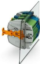
Prüfsteckleiste, Nennspannung: 400 V, Anzahl der Anschlüsse: 12, Polzahl: 6, Anschlussart: Ringkabelschuh, Bemessungsquerschnitt: 6 mm<sup>2</sup>, 1. Etage, Farbe: grün/blau
