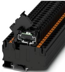
Sicherungsreihenklamm, Art der Sicherung: Glas / Keramik / ..., Sicherungstyp: G / 6,3 x 32, Nennspannung: 24 V, Nennstrom: 10 A, Anschlussart: Push-in-Anschluss, Querschnitt: 0,5 mm<sup>2</sup>- 16 mm<sup>2</sup>, Farbe: grau
