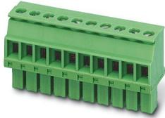
Leiterplattenstecker, Nennquerschnitt: 1,5 mm<sup>2</sup>, Farbe: lichtgrau, Nennstrom: 8 A, Bemessungsspannung (III/2): 160 V, Kontaktoberfläche: Sn, Kontaktart: Buchse, Anzahl der Reihen: 1, Polzahl: 2, Artikelfamilie: MCVW 1,5/..-ST-A, Rastermaß: 3,81 mm, Anschlussart: Schraubanschluss mit Zughülse, Schraubenangriffsform: L Längsschlitz, Anschlussrichtung Leiter/Platine: -90 °, Stecksystem: COMBICON MC 1,5, Verriegelung: ohne, Befestigungsart: ohne, Verpackungsart: verpackt im Karton
