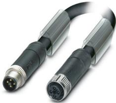
Powerleitung, 4-polig, PVC, schwarzgrau RAL 7021, Stecker gerade M12, Kodierung: T, auf Buchse gerade M12, Kodierung: T, Kabellänge: 10 m, für Gleichstrom bis 12 A / 63 V
