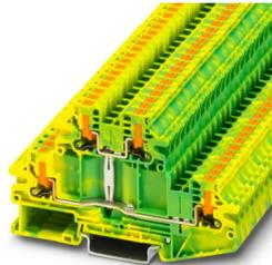
Schutzleiter-Doppelstockklemme, Anzahl der Anschlüsse: 4, Anschlussart: Push-in-Anschluss, 1. und 2. Etage, Bemessungsquerschnitt: 4 mm<sup>2</sup>, Querschnitt: 0,2 mm<sup>2</sup> - 6 mm<sup>2</sup>, Montageart: NS 35/7,5, NS 35/15, Farbe: grün/gelb
