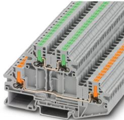
Doppelstockklemme, Nennspannung: 800 V, Nennstrom: 22 A, Anschlussart: Push-in-Anschluss, 1. und 2. Etage, Bemessungsquerschnitt: 2,5 mm<sup>2</sup>, Querschnitt: 0,14 mm<sup>2</sup> - 4 mm<sup>2</sup>, Montageart: NS 35/7,5, NS 35/15, Farbe: grau
