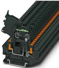
Sicherungsreihenklemme, Art der Sicherung: Glas / Keramik / ..., Sicherungstyp: G / 5 x 20, Nennspannung: 60 V, Nennstrom: 6,3 A, Anschlussart: Push-in-Anschluss, 1. Etage, Bemessungsquerschnitt: 4 mm<sup>2</sup>, Querschnitt: 0,2 mm<sup>2</sup>- 6 mm<sup>2</sup>, Montageart: NS 35/7,5, NS 35/15, Farbe: schwarz
