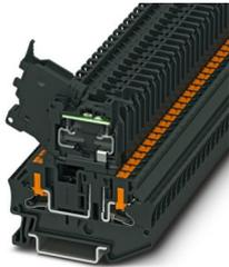
Sicherungsreihenklemme, Art der Sicherung: Glas / Keramik / ..., Sicherungstyp: G / 5 x 20, Nennspannung: 24 V, Nennstrom: 6,3 A, Anschlussart: Push-in-Anschluss, 1. Etage, Bemessungsquerschnitt: 4 mm<sup>2</sup>, Querschnitt: 0,2 mm<sup>2</sup>- 6 mm<sup>2</sup>, Montageart: NS 35/7,5, NS 35/15, Farbe: schwarz
