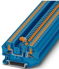
Messertrennklemme, Nennspannung: 500 V, Nennstrom: 20 A, 1. Etage, Anschlussart: Push-in-Anschluss, Bemessungsquerschnitt: 4 mm<sup>2</sup>, Querschnitt: 0,2 mm<sup>2</sup> - 6 mm<sup>2</sup>, Montage: NS 35/7,5, NS 35/15, Farbe: blau
