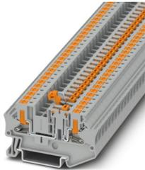
Messertrennklemme, Nennspannung: 500 V, Nennstrom: 20 A, 1. Etage, Anschlussart: Push-in-Anschluss, Bemessungsquerschnitt: 4 mm<sup>2</sup>, Querschnitt: 0,2 mm<sup>2</sup> - 6 mm<sup>2</sup>, Montage: NS 35/7,5, NS 35/15, Farbe: grau
