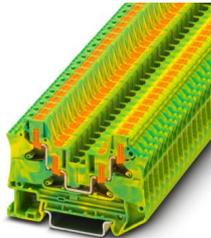
Schutzleiter-Reihenklemme, Anzahl der Anschlüsse: 4, Anschlussart: Push-in-Anschluss, 1. Etage, Bemessungsquerschnitt: 4 mm<sup>2</sup>, Querschnitt: 0,2 mm<sup>2</sup> - 6 mm<sup>2</sup>, Montageart: NS 35/7,5, NS 35/15, Farbe: grün/gelb
