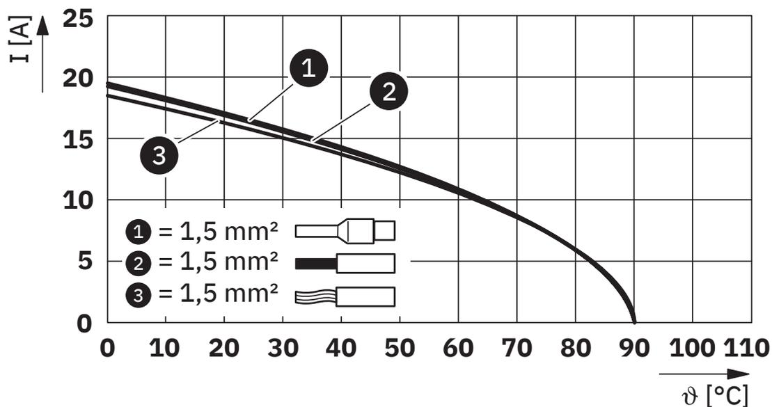
Derating-Diagramm für 1,5 mm<sup>2</sup>
