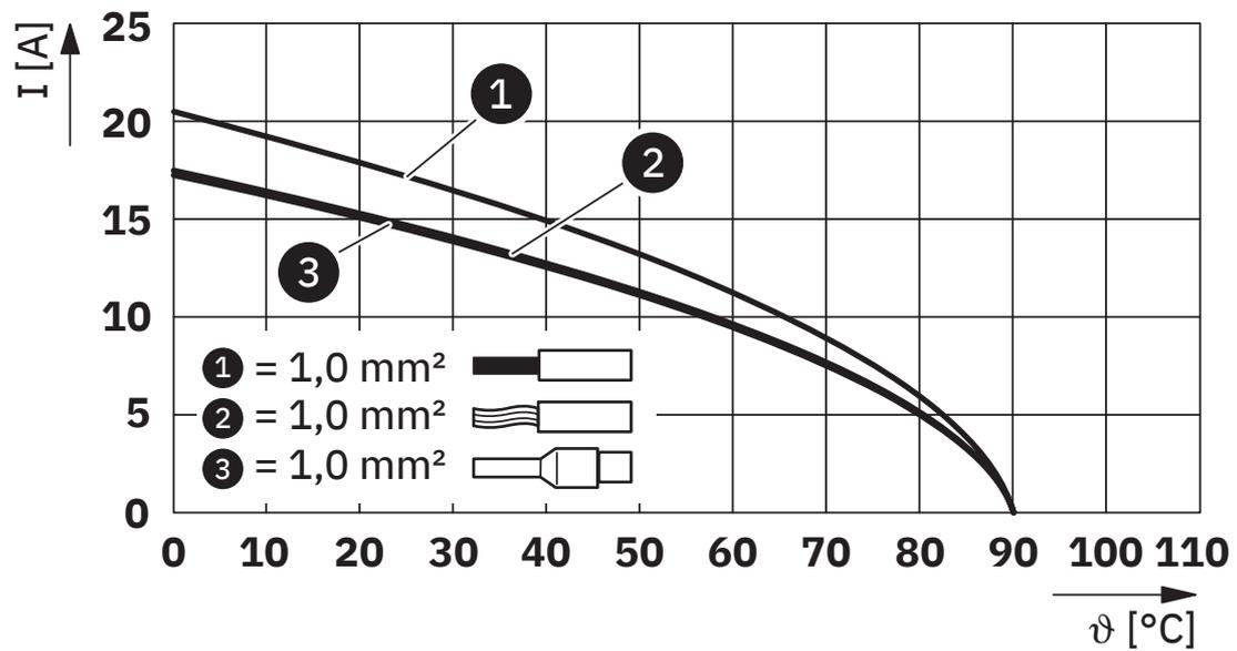
Derating-Diagramm für 1,0 mm<sup>2</sup>
