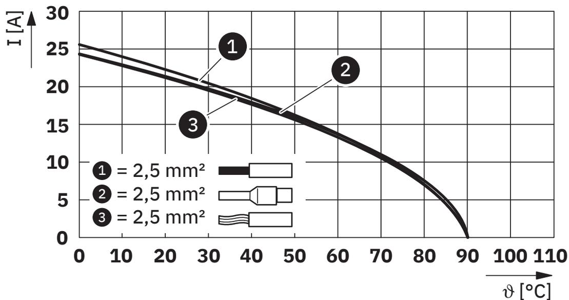
Derating-Diagramm für 2,5 mm<sup>2</sup>
