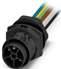
Wanddurchführung, für Steckverbinder, Anschlussart: Einzeladern, Polzahl: 4+PE, M25, Stift, 450 V, 17,5 A, PA, schwarz, Kodierung: P, 2,5 mm<sup>2</sup>, Leitungslänge: 0,5 m
