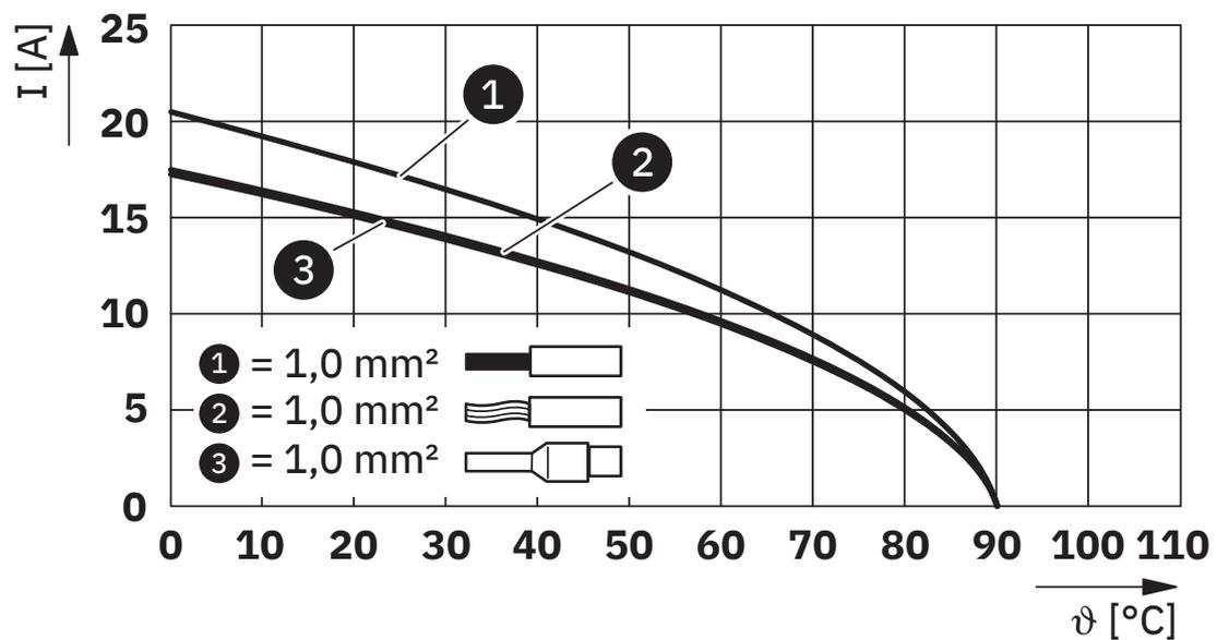
Derating-Diagramm für 1,0 mm<sup>2</sup>
